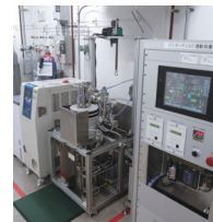
水素雰囲気下での摩擦摩耗試験機
