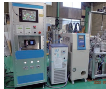
水素雰囲気下での摩擦摩耗試験設備
