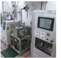
水素雰囲気下での摩擦摩耗試験機
